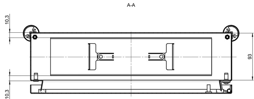
Verstärkerplatte an Seite A oder B, je nach Kupplungsbohrung
