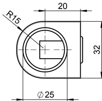
Adapter Signalleuchte L=150mm
